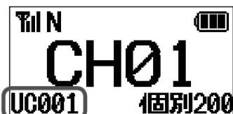
**補足** ディスプレイの右下に“個別”、“グループ”または“ALL”が表示されていない場合は UC 通信方式になっています。あらかじめセットモードの「S01 通信方式」(33 ページ参照) で“個別通信”に設定してください。
