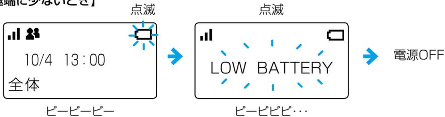
※残量表示が「
