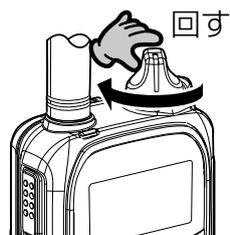
※防塵/防水対応により、簡単に回らない構造になっています。
