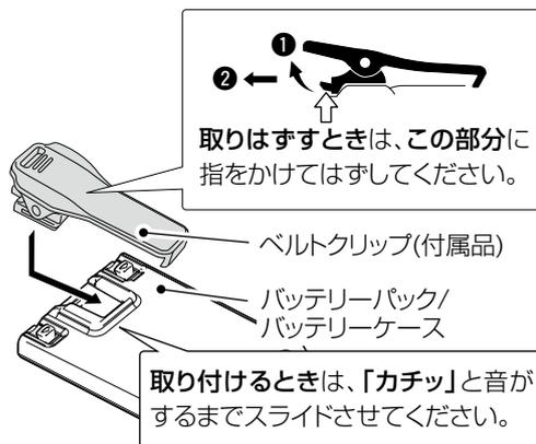
※バッテリーパック/バッテリーケースを無線機本体から取りはずした状態で、ベルトクリップを着脱してください。
