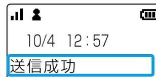
※送信先が個別の場合だけ、表示部に送信結果(送信成功/応答なし)が表示されます。
